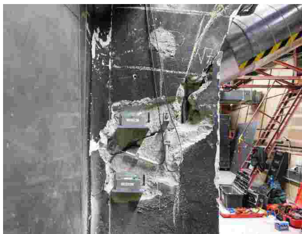
Foto z instalace 21.2.2023. 2x snímače DH15 + 2x náklonoměr IOTIN.
