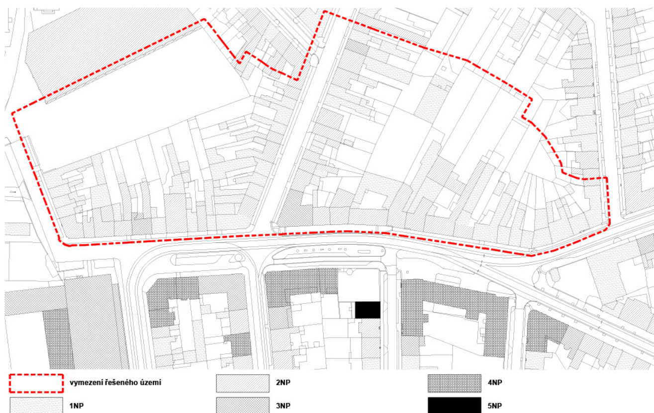
B342_p159_22z – stávající výška zástavby v řešené lokalitě
