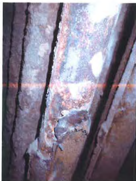
Obr. 2.2-3 – Trubky trubkového svazku, nános P4160047 –
