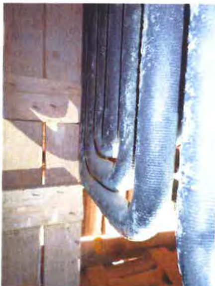
Obr. 2.3-6 – Trubky přehříváku páry kryté návarem P4160055 –
